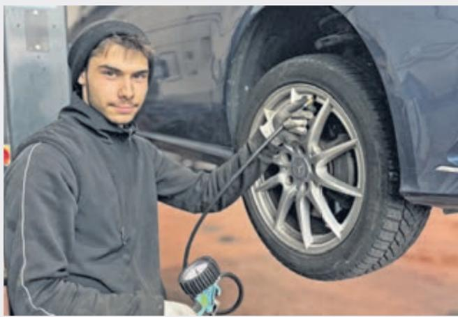
Nach dem Räderwechsel wird der richtige Reifendruck eingestellt. „Bereits bei einem halben Bar zu wenig, kann dies den Bremsweg, die Kurvenlage und den Spritverbrauch negativ beeinflussen“, so Azubi Marlon Bär von Kfz-Service Klauber & Schwenk. Foto: Klauber & Schwenk
