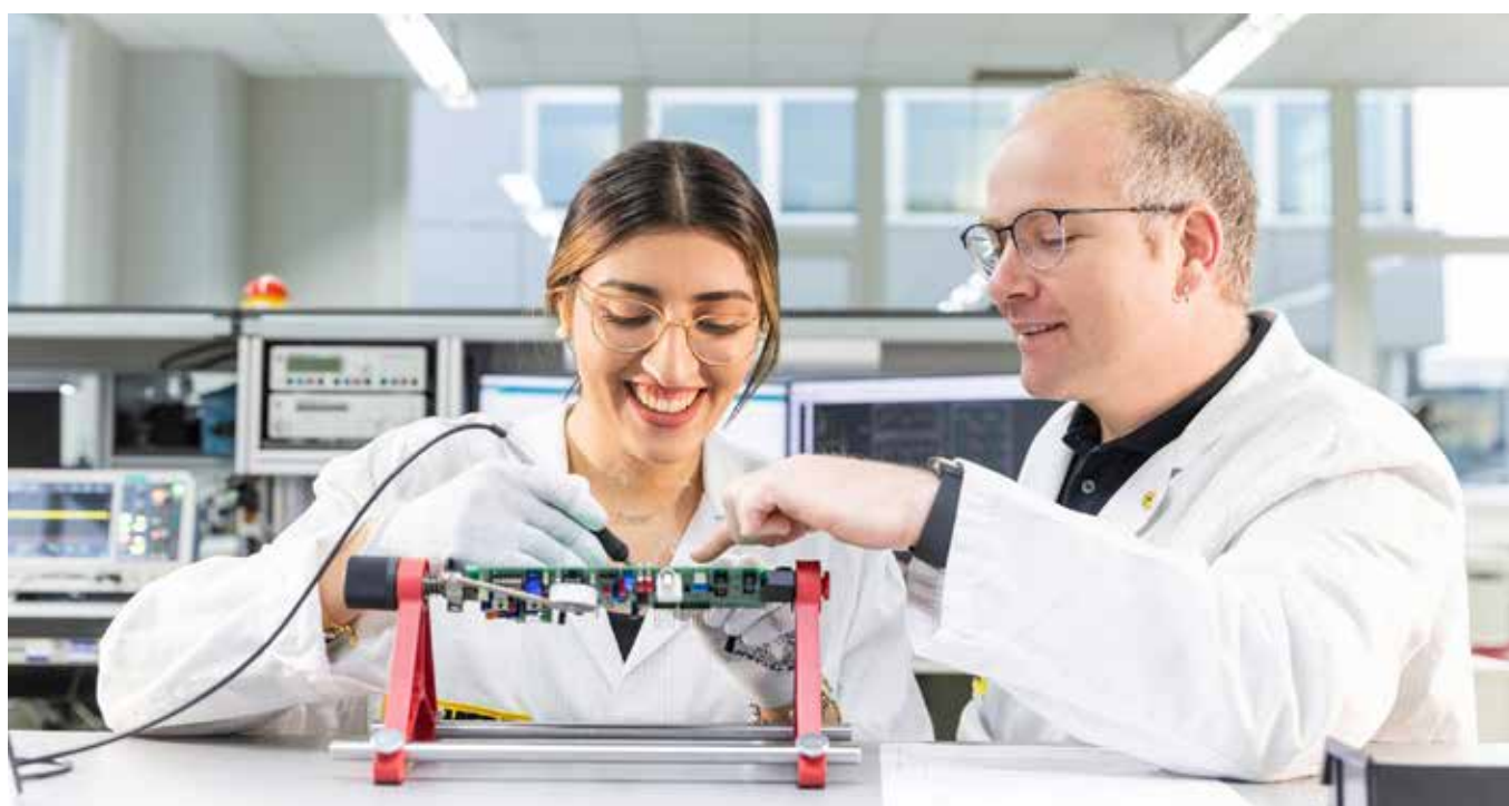
Elektronikerin beim Bestücken einer Leiterplatte.
