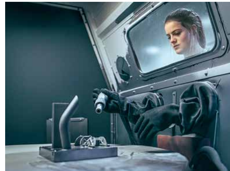
Nachbearbeitung der 3D-Druck Teile mittels Sandstrahlen.
